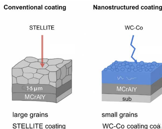
شکل ۴. مقایسه ریز ساختار مقاوم به فرسایش پوشش های نوین WC-Co در مقایسه با پوشش های سنتی استلایت [۲۸].
